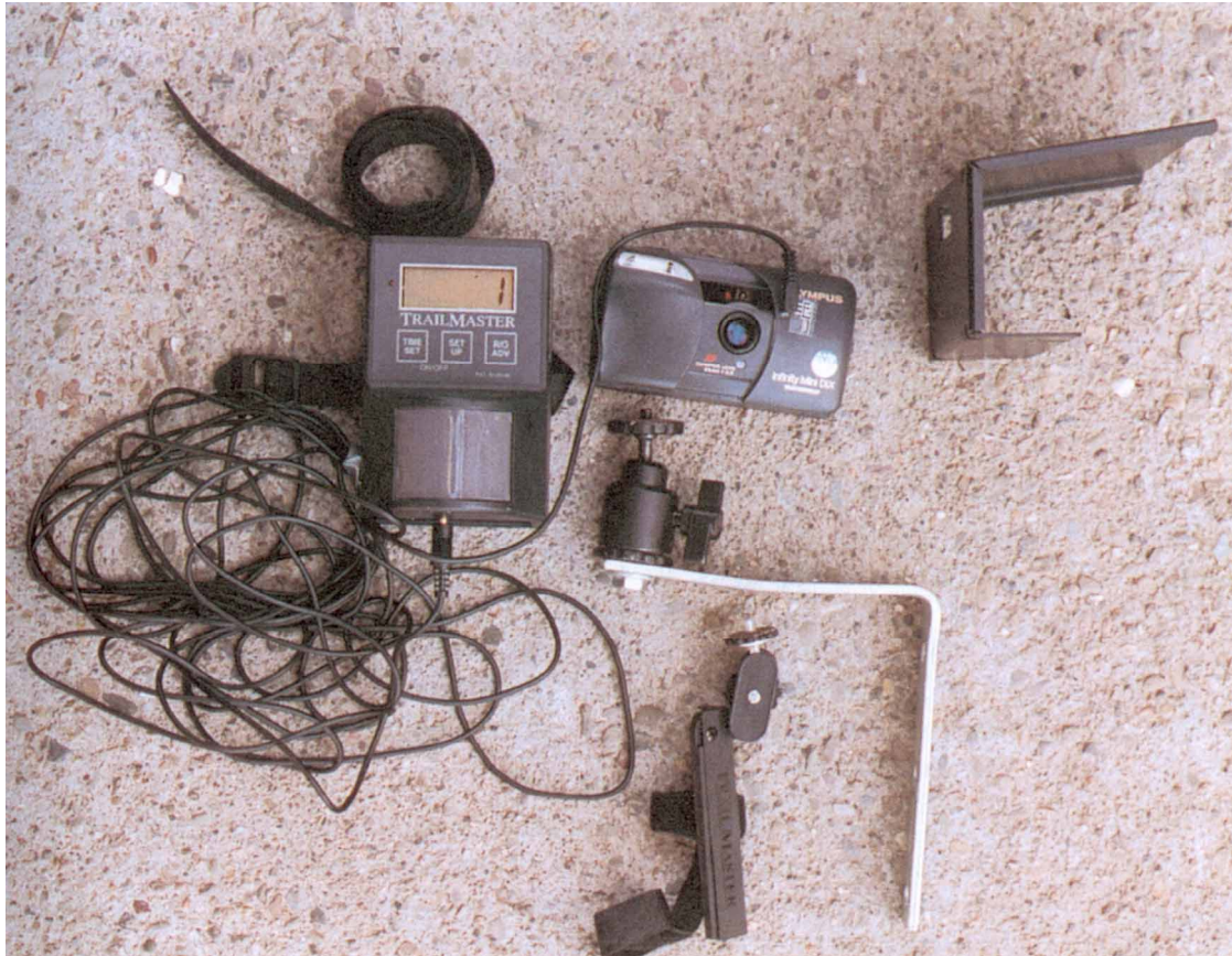
Figure 1 : le système Trailmaster TM550 à déclenchement infrarouge passif. De gauche à droite : détecteur, appareil photo, plaque de protection. Juste en dessous de l'appareil, système de fixation à l'arbre avec un trépied. L'appareil photo est relié au détecteur par un fil de 8m. (tirée de Zielinsky et Kucera, 1995).
